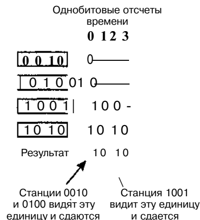
Рис. 4.7. Протокол с двоичным обратным отсчетом. Прочерк означает молчание
