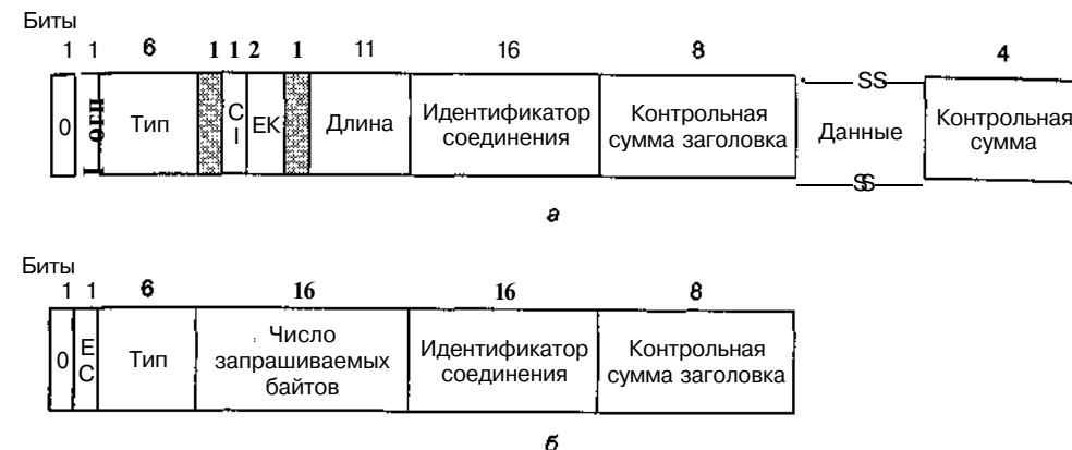
Рис. 4.31. Обычный кадр (а); кадр запроса канала (б)
