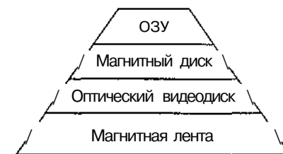
Рис. 7.45. Иерархия хранилища видеосервера
