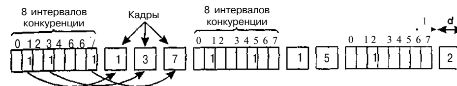
Рис. 4.6. Базовый протокол битовой карты
