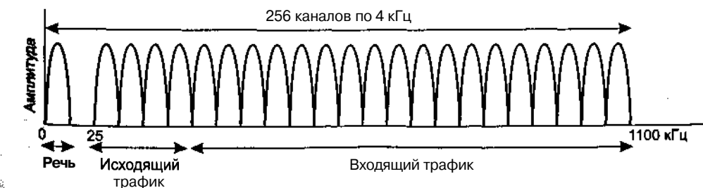
Рис. 2.24. Работа ADSL с использованием дискретной мультитональной модуляции
