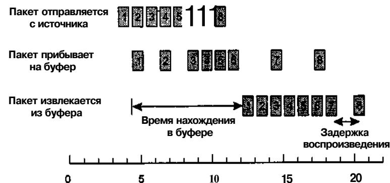
Рис. 5.27. Сглаживание выходного потока путем буферизации пакетов
