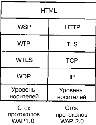
Рис. 7.25. WAP 2.0 поддерживает два стека протоколов
